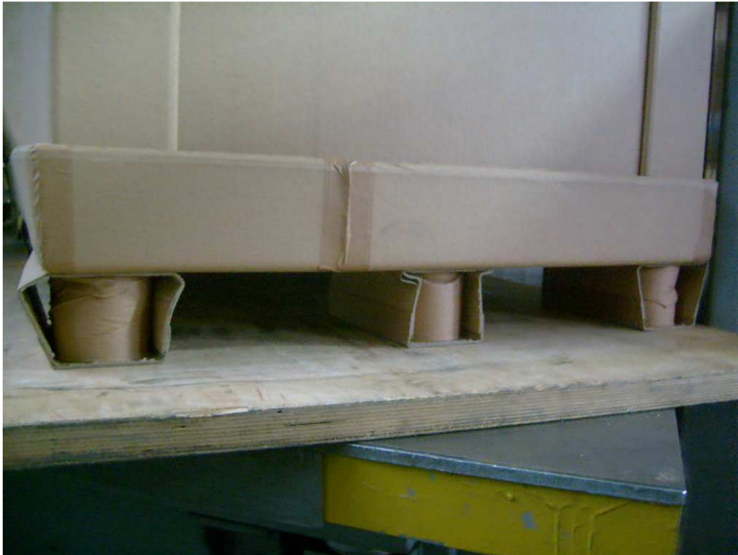
Fot. 8. Załamanie konstrukcji – załamanie stup kontenera.
