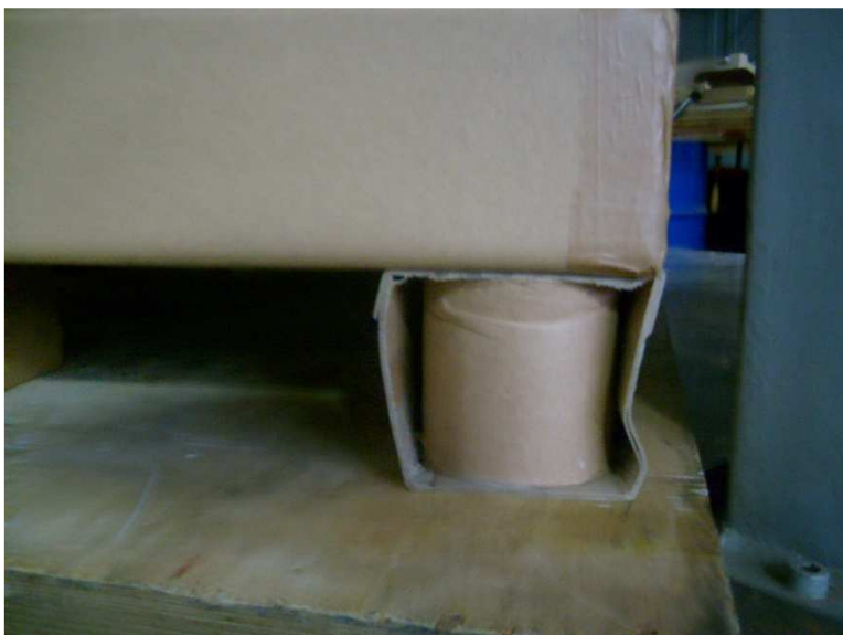
Fot. 4. Załamanie konstrukcji – załamanie stóp kontenera
