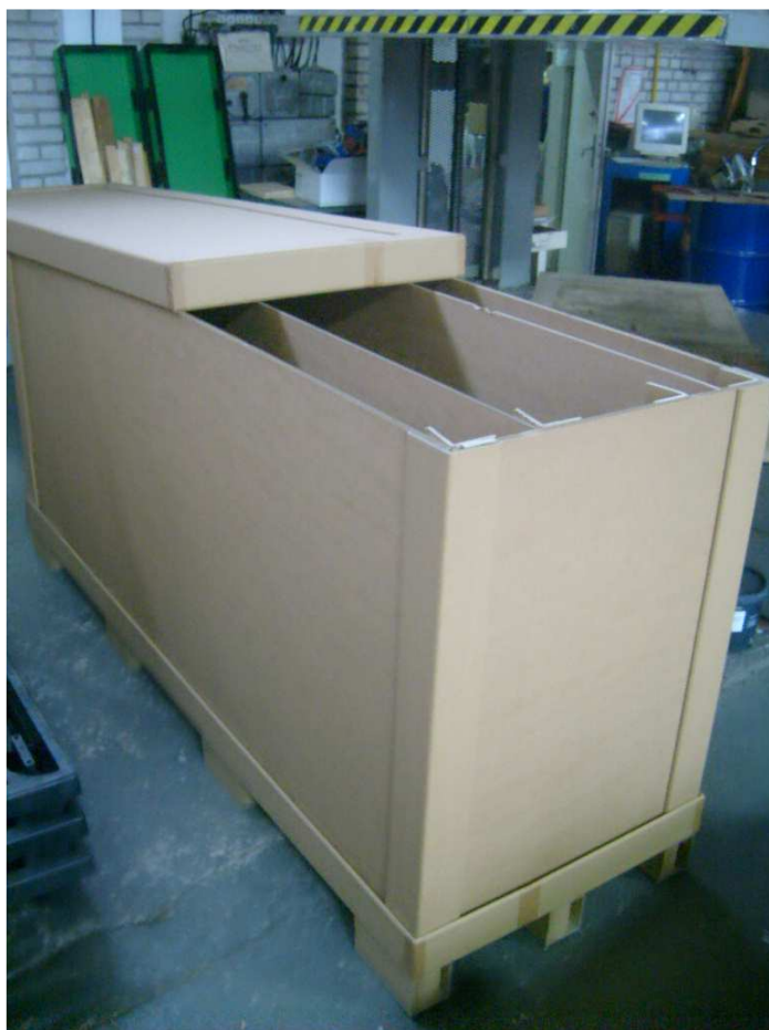
Fot. 3. Kontener ze stopami i wyposażeniem wewnętrznym.
