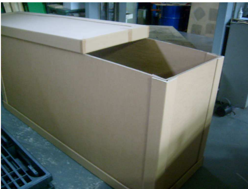
Fot. 5. Kontener bez stup i bez wyposażenia wewnętrznego.
